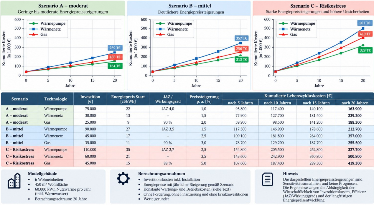
Abbildung 5: Dynamische Lebenszykluskosten über 20 Jahre für Wärmepumpe, Wärmenetz und Gas in drei Szenarien (kumulierte Gesamtkosten). Anmerkung: Dargestellt sind die kumulierten Kosten aus Investition und Betrieb (Energiekosten, Grund-/Leistungspreise, Wartung) für ein Mehrfamilienhaus mit 6 Wohneinheiten, 450 m² Wohnfläche und 60.000 kWh Nutzwärme pro Jahr. Keine Berücksichtigung von Förderung, Finanzierung, Abzinsung und Ersatzinvestitionen. Preissteigerungen gemäß Szenario (A: 1,0–2,0 % p. a.; B: 1,5–3,0 % p. a.; C: 2,5–5,0 % p. a.). Quelle: Eigene Berechnungen und Darstellung auf Basis von Destatis (2026) [1], Verbraucherzentrale (2024) [2] sowie technischer und wirtschaftlicher Modellannahmen (siehe Kapitel 26).
